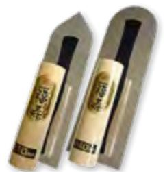
Eine gute Verarbeitungstechnik wächst mit dem Werkzeug. In Japan hat Lehmputz Tradition und die Oberflächenbearbeitung von Lehmputzen einen hohen Stellenwert. Dort sind diese speziellen Kellen entwickelt worden.
