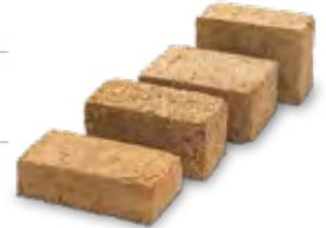
Leichtlehmsteine werden in einem der traditionellen Handformung nachempfundenen Verfahren hergestellt. Leichtlehmsteine NF 1200 sind für die Ausmauerung von Fachwerk besonders geeignet. Alle Leichtlehmsteine können im Innenbereich für nicht tragendes Mauerwerk und Vorsatzschalen verwendet werden. Die unterschiedlichen Raumgewichte entstehen durch die Beigabe von organischen Zuschlägen.
