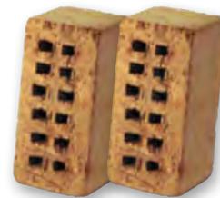
Die Lehmsteine DF und NF werden im Innenbereich für Wandausfachungen, Deckenauflagen, Vorsatzschalen, trockene Stapelwände und Mauerwerk eingesetzt. Sie gehören zur Anwendungsklasse II und sind daher nicht für Außengefache geeignet.
