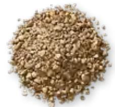
Die Lehm-Deckenschüttung wird zur Massebeschwerung in der Decke verwendet. Sie ist keine Dämmung, sondern dient dem Schallschutz.
