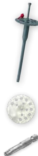
Die Länge der Befestigungsmittel ist entsprechend der Dicke der Holzfaserdämmplatten und des Untergrundes zu wählen. Schraubdübel sind für Mauerwerk und die Dämmstoffhalter für Holzbauteile. Für die Dübel 35.050 – 35.055 wird ein Spezial-Bit benötigt, um diese perfekt anzubringen bzw. entsprechend zu spreizen. Dieser wird jeder Verpackung beigelegt.
